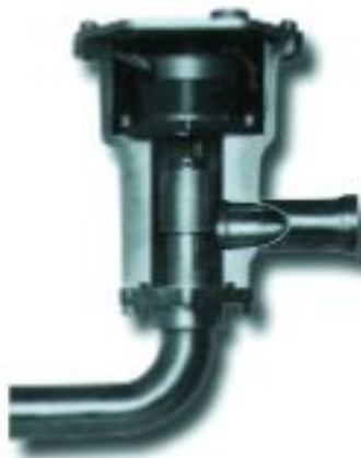
FIGURA 1.9 VÁLVULA EXPANSIÓN
